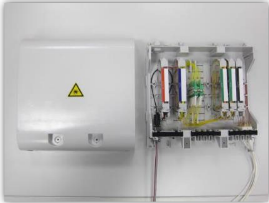
Beispiel einer One Box (Glasfaser Abschlusspunkt)
