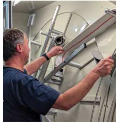
waschprogramm und Kupplungsreinigungssystem wird eine optimale Reinigung der Schläuche erreicht. Durch einen prozessgesteuerten Programmablauf kann der gesamte Schlauchpflegevorgang bearbeitet werden. Lediglich das Kup-
