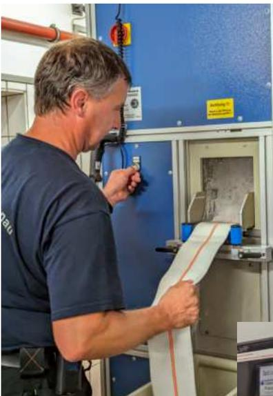
Der zu reinigende Schlauch wird zunächst in die Anlage eingeführt, in welcher er gewaschen wird. Hierzu wird stets frisches und sauberes Wasser genutzt. Die moderne Touch-Screen-Bedieneinheit informiert dabei über
